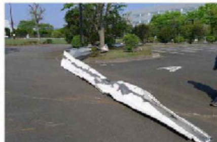
飛散した飛来物（鋼板製屋根材）
