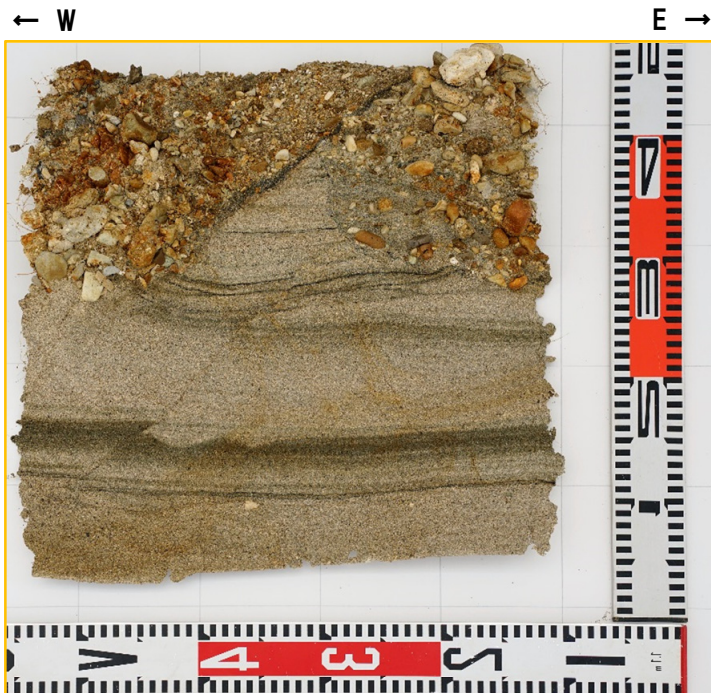
拡大写真①(北側壁面距離呈17m付近, はぎとり転写試料(左右反転)(解釈線なし))
