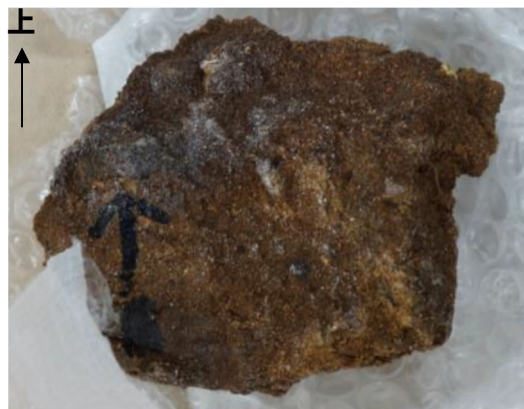
薄片試料写真(作成前) 5cm
