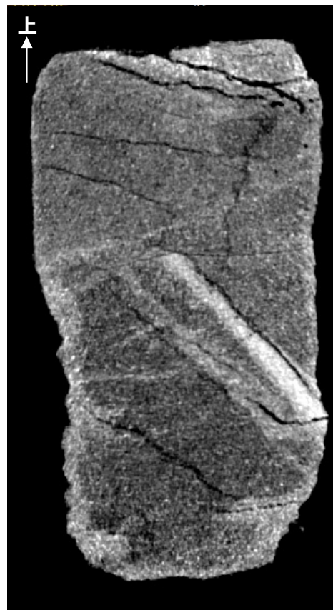
X線CT画像 (傾斜方向断面, 解釈線なし) (断面(A): 研磨片作成位置断面から手前方向に約5mmの位置)
