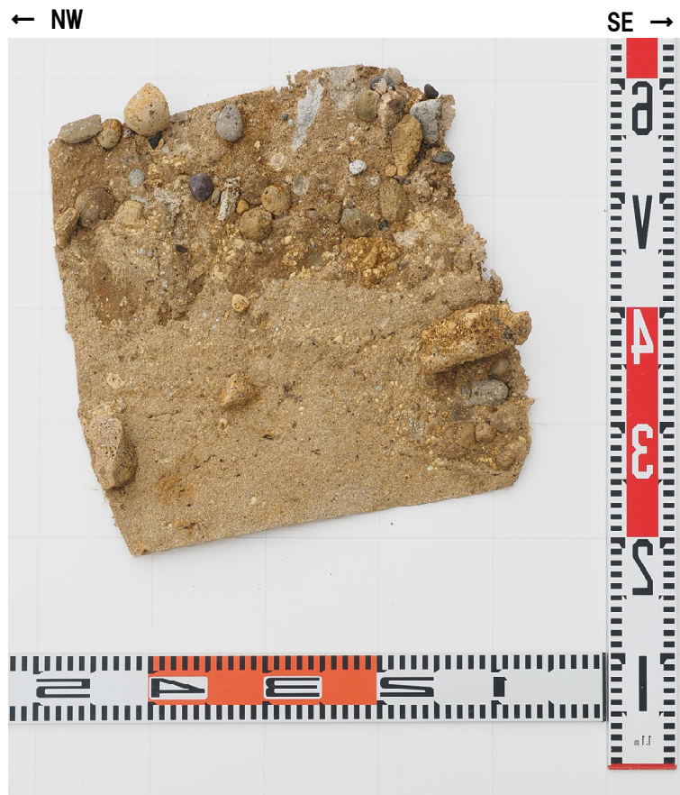
はぎとり転写試料写真(左右反転)(解釈線なし)
