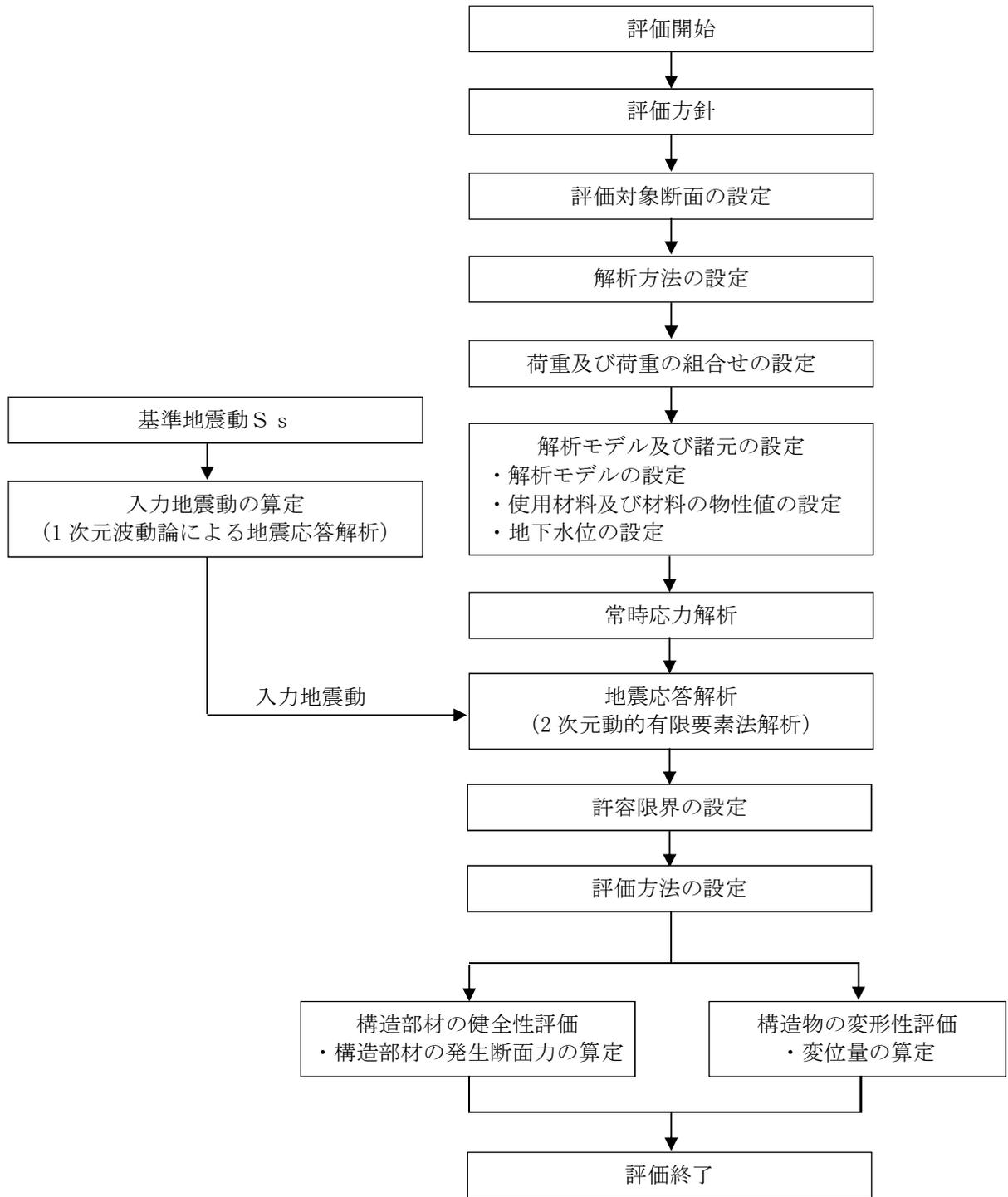
図 2-4 取水護岸 (6 号機設備) の耐震評価フロー
