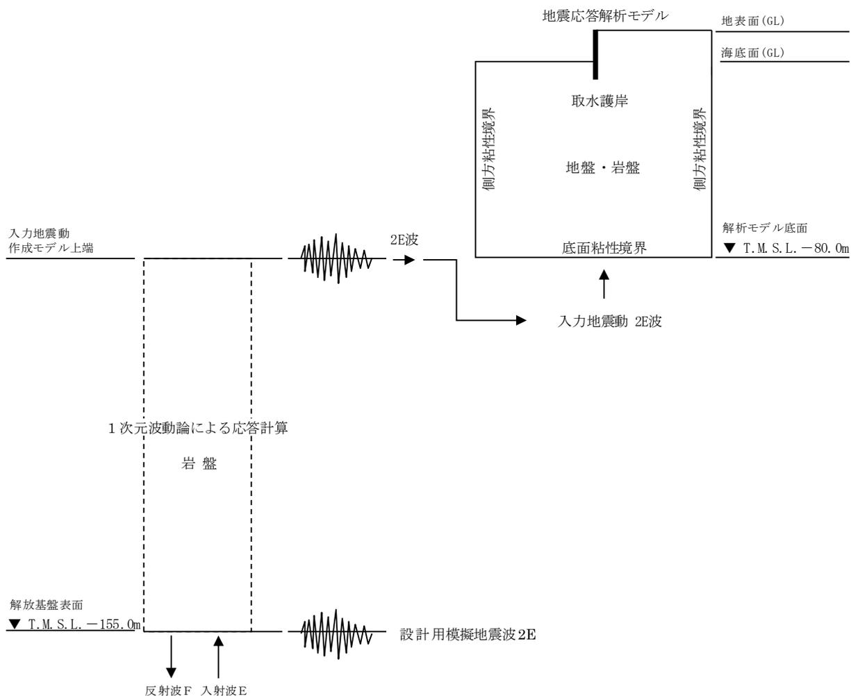
図 3-3 入力地震動算定の概念図
