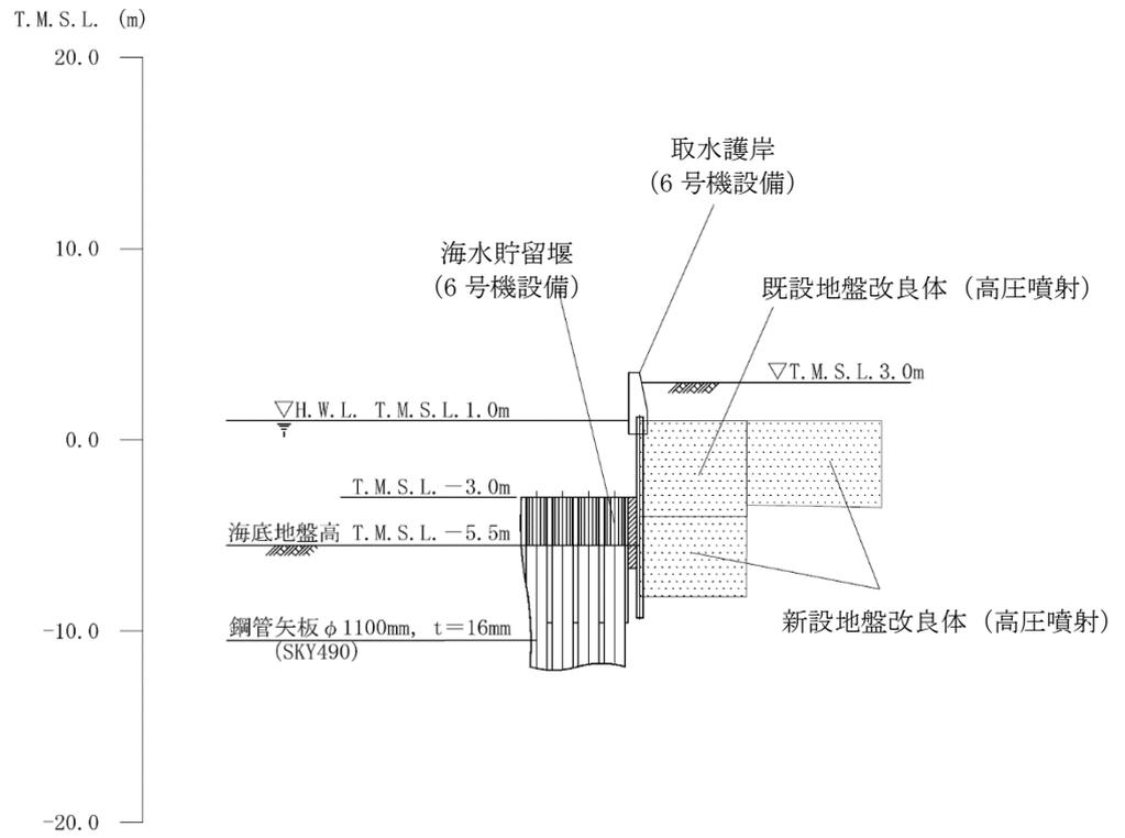
図 2-3 取水護岸 (6号機設備) の標準断面図 (A-A断面)
