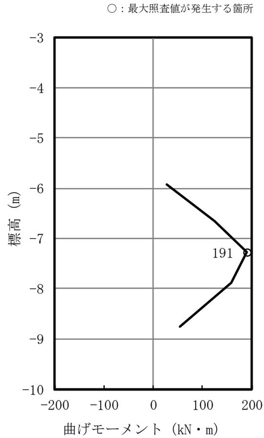
図 3-6 (2) 前面鋼矢板(海底面以深)の曲げモーメント照査における
