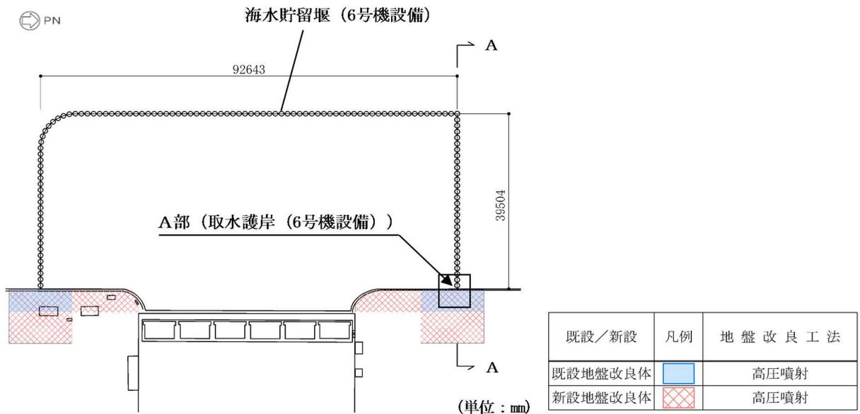
図2-2 (1) 取水護岸（6号機設備）の平面図
