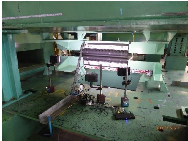
(b) 小型供試体の設置状況
