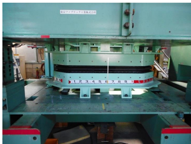
(c) 矩形供試体の設置状況
