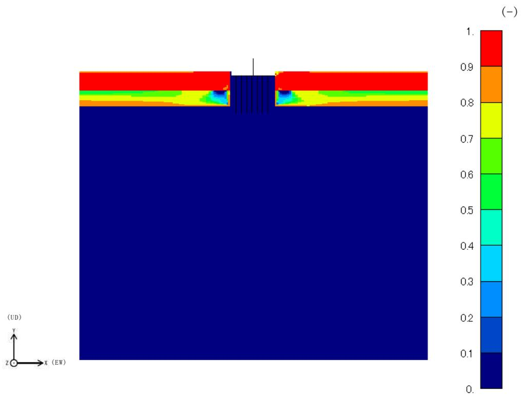
図 3-12 地盤の最大過剰間隙水圧比 (Ss-1, EW 方向)
