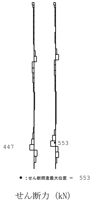
図 4-4 (1) 鋼管杭のせん断力照査における最大照査値の評価時刻での断面力 (杭一本あたり) (A-A断面, Ss-1--, t=5.24s) (検討ケース③: 地盤物性のばらつき (-1 \sigma ) を考慮した解析ケース)
