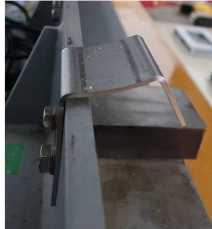
図 2-1 クリップの固定状態及び脱落状態
