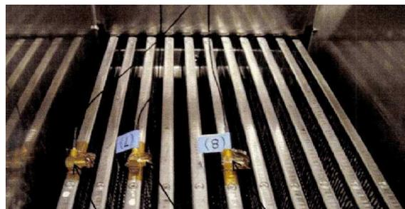
図2 触媒カートリッジの収納状態
