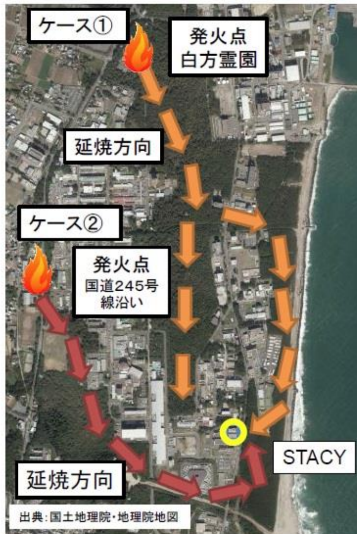
図4-2 発火点及び延焼の考え方
