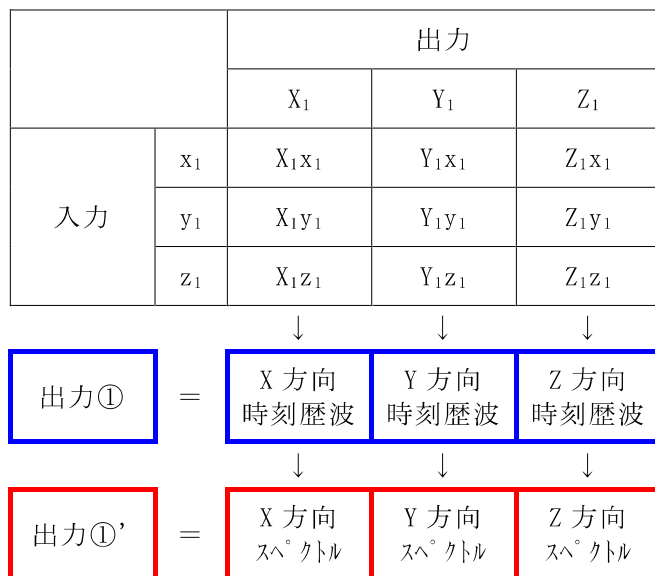
図 3-4 3 次 FEM モデルによる応答算出の考え方
