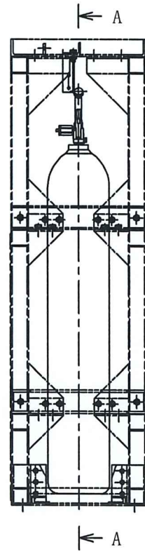
6801列1本用ポンベラック設置
