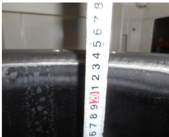
吸着槽1 充填高さ
