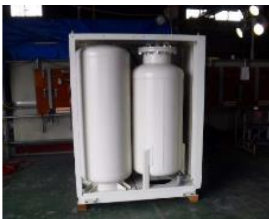
吸着槽1の外観
