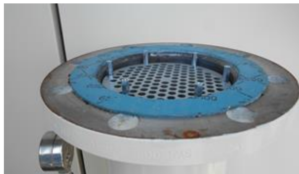
活性炭槽 上蓋取り外し後
