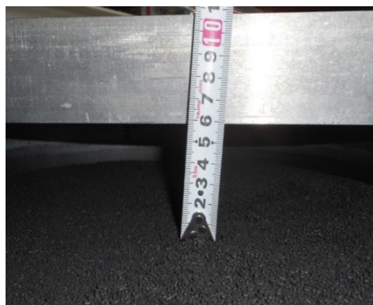
吸着槽2 充填高さ
