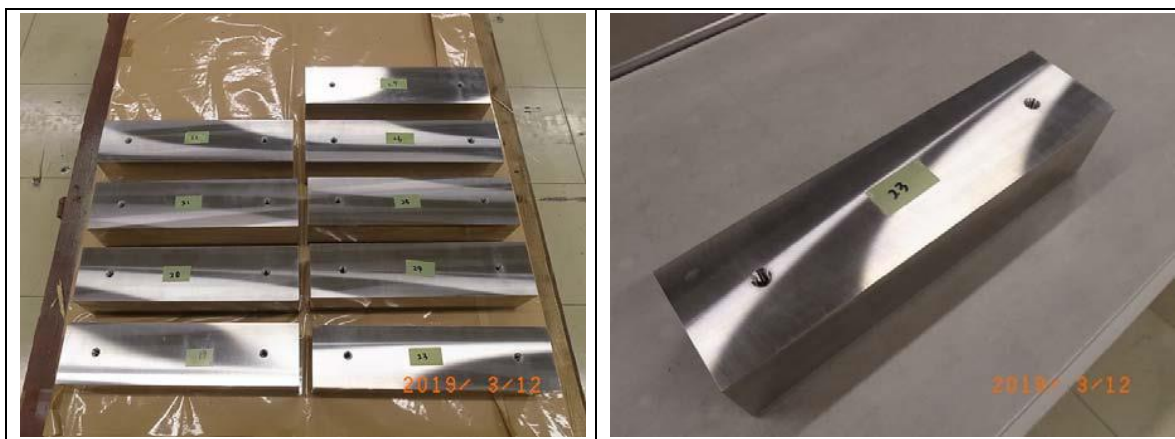
図 7.2-3 RAJ-III S 型核燃料輸送物 保護ケース用充填材 2
