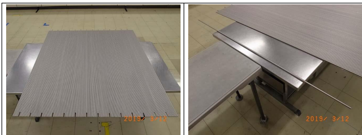
図 7.2-4 RAJ-III S 型核燃料輸送物 保護ケース用充填棒
