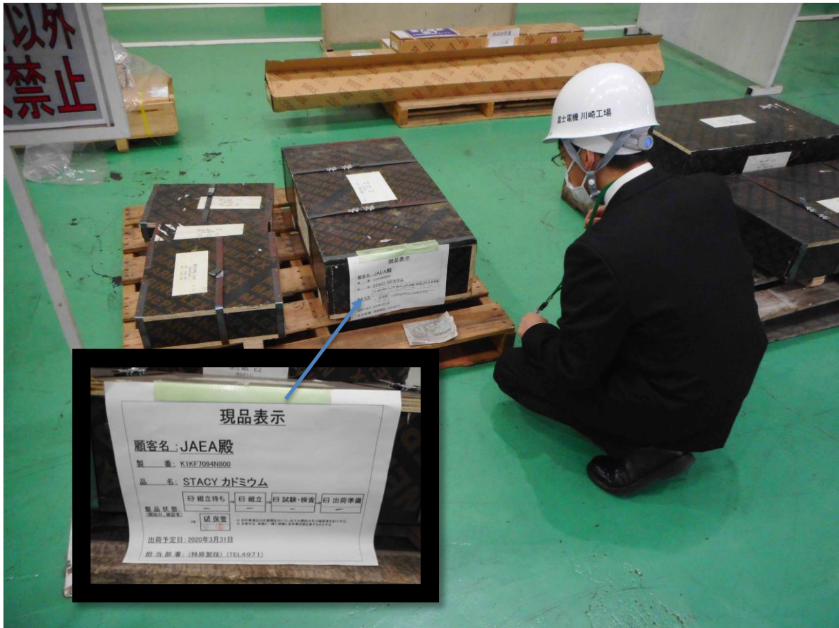
図 6.2.2-1(1) 安全板装置及び棒状燃料貯蔵設備Ⅱの製作に必要な部品（カドミウム板）
