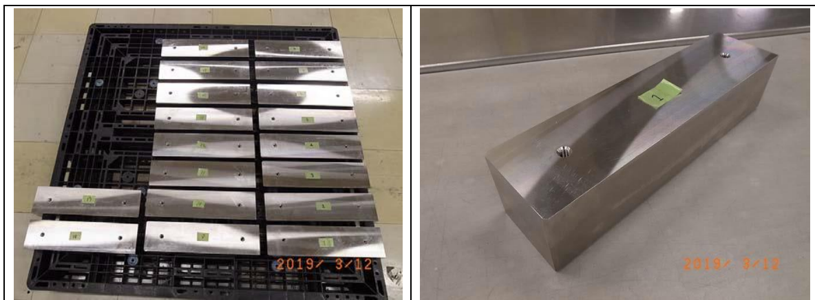
図 7.2-2 RAJ-III S 型核燃料輸送物 保護ケース用充填材 1
