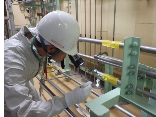
图 6.1-9 耐压漏えい検査
