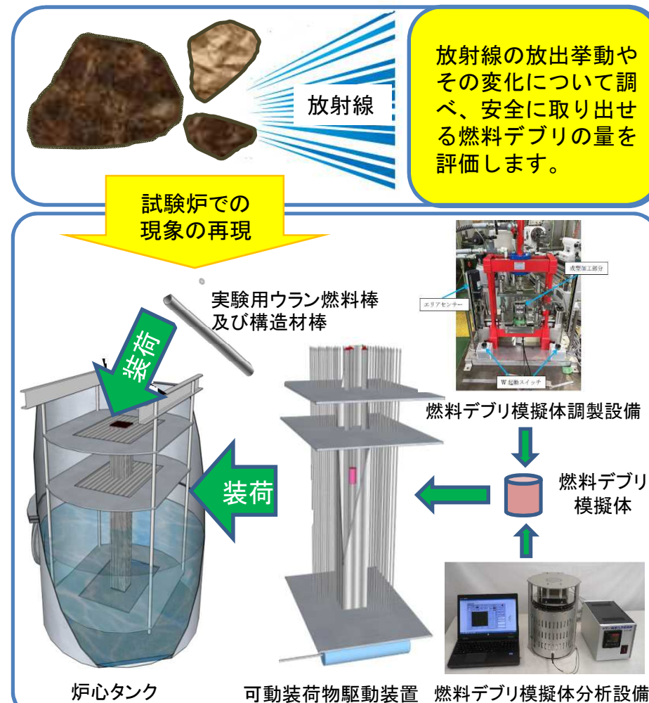
図1 試験炉における燃料デブリ模擬体を用いた実験の進め方例 (一部国立研究開発法人日本原子力研究開発機構の公開資料より抜粋)
