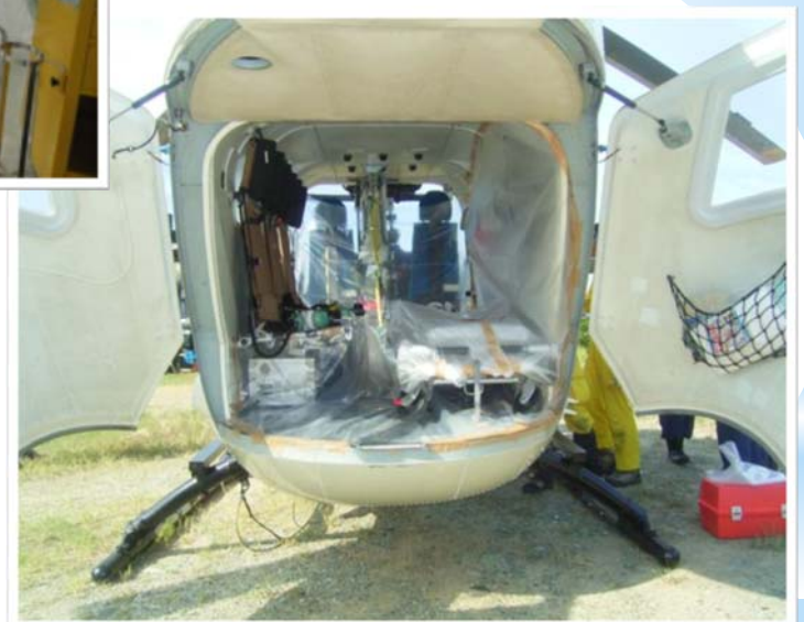
ヘリ搬送時の養生
