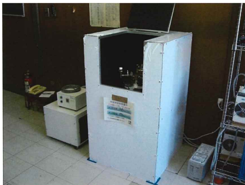
図 3-8-1(2) 大気中の希ガス捕集装置 (写真は北海道立衛生研究所に設置した装置)
