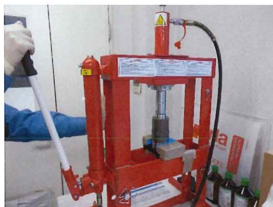
図 2-2-9 測定試料整形用のプレス機
