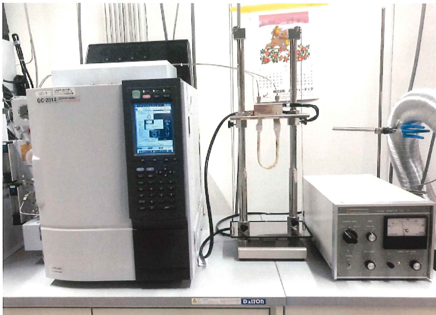
図 3-8-5 ガスクロマトグラフ 1 (クリプトン粗分離用)
