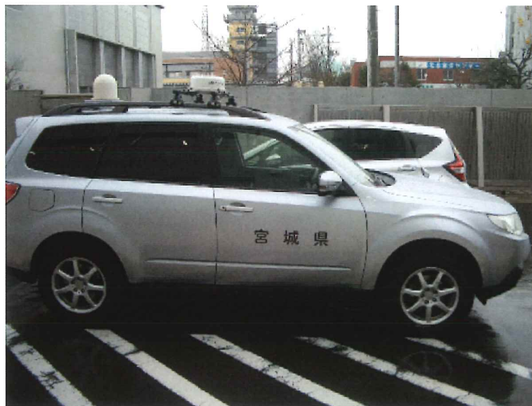
図 6. 2. 36 RAMPU を搭載するモニタリングカー
