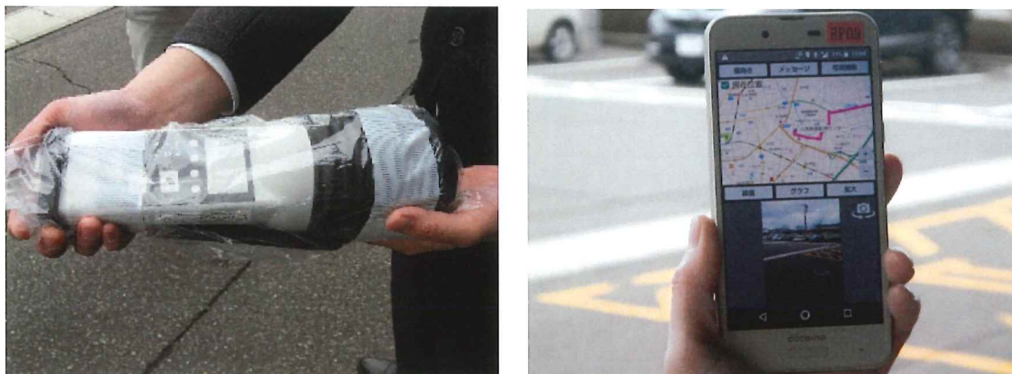
図 6.2.22 新潟県のラジプローブ (左：測定器、右：車載監視端末のスマートフォン)
