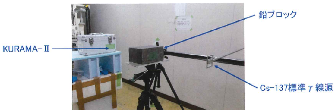
図5.3.6 KURAMA-IIの感度確認試験の様子
