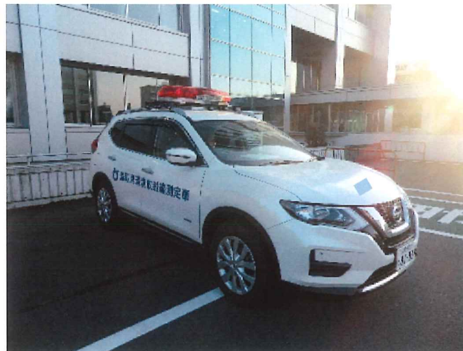
図 6.2.10 KURAMA-II を搭載するサーベイ車
