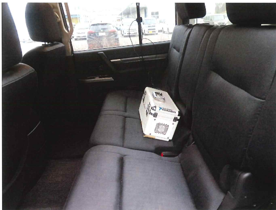
図 6.2.4 KURAMA-II の設置イメージ
