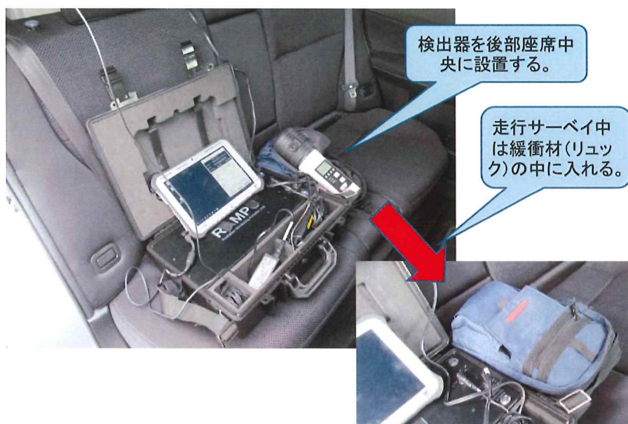
図 6.2.38 RAMPU 設置の様子
