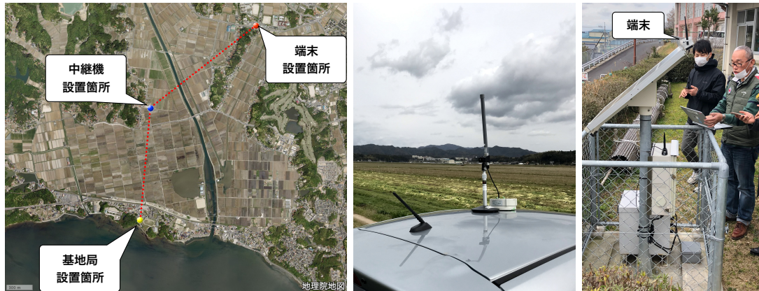
図 34 生馬公民館との通信試験。(左) 基地局、中継機、端末の位置関係。端末と基地局の間には山があり、加えて原子力環境センターから見た時、端末は保健環境センターの影に隠れてしまう状況であった。(中) 中継機の設置状況を端末の設置されている生馬公民館方面を眺める形で撮影したもの。公民館は見通せないものの、隣接する小学校が見通せる状態。端末の設置されている公民館は小学校のさらに向かって右奥になる。(右) 端末設置の様子。モニタリングポストの太陽電池パネル上部に置いた。
