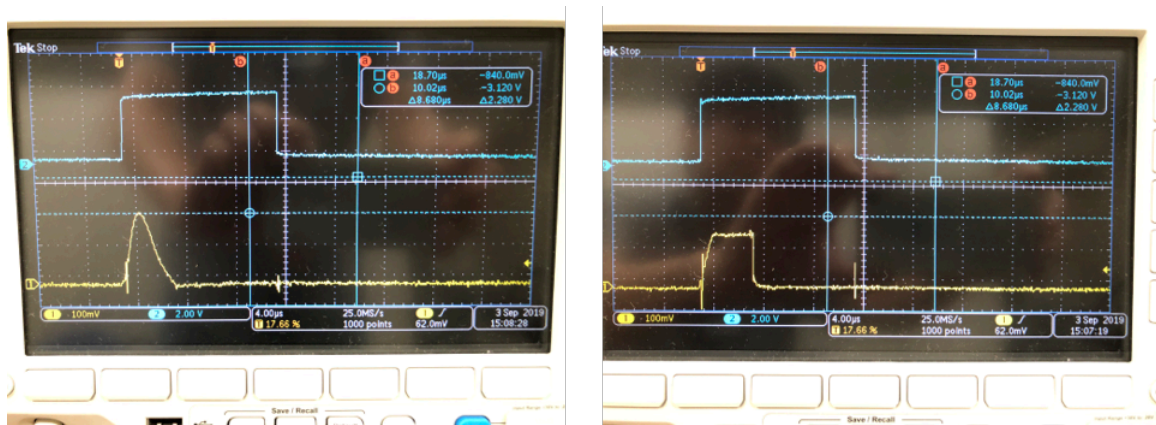
図 44 改造した C12137 から取り出した信号。黄色の波形はそれぞれ波形整形アンプの出力（左）とピークホールド信号（右）で、青色の波形がゲート信号。
