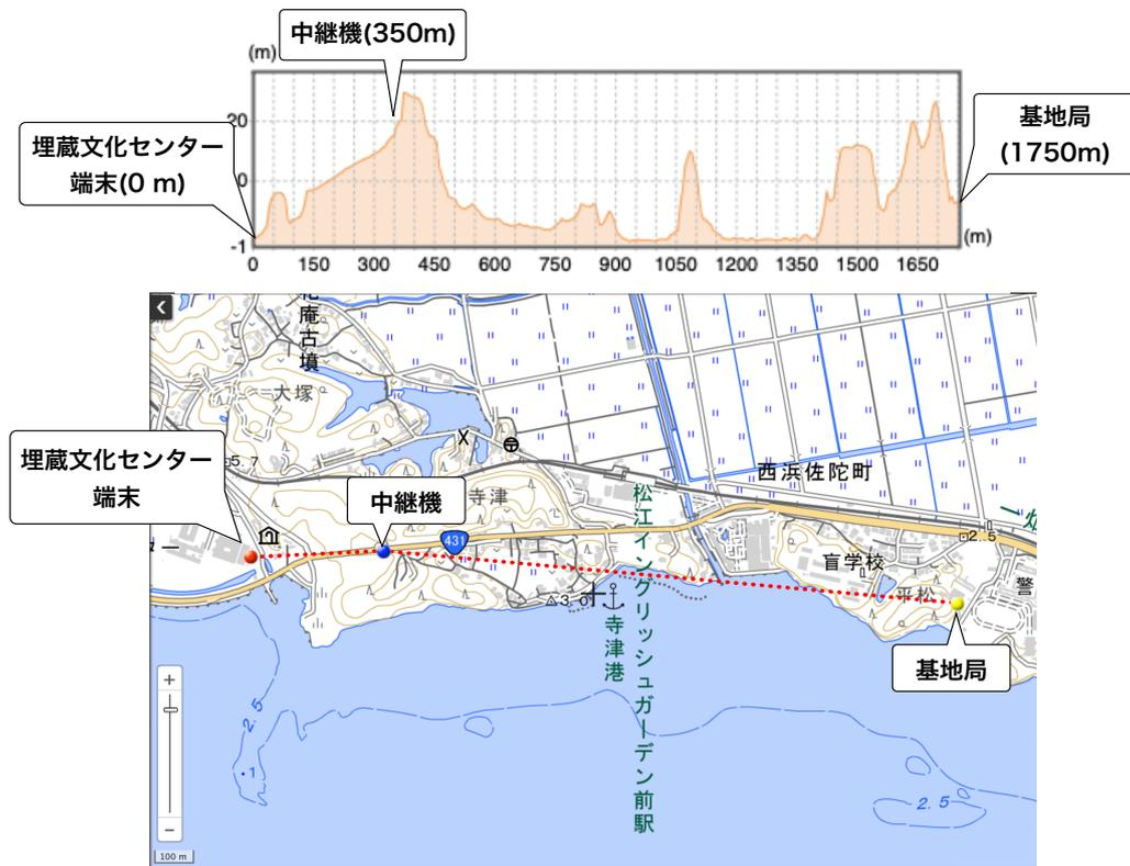
図 32 埋蔵文化センターの端末、および中継局と島根県原子力環境センターの基地局との位置関係および経路上の高度図（上）。
