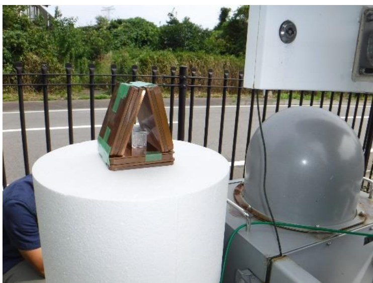
図8 下方向及び屋根による側面2方向、上方方向を遮へいした場合
