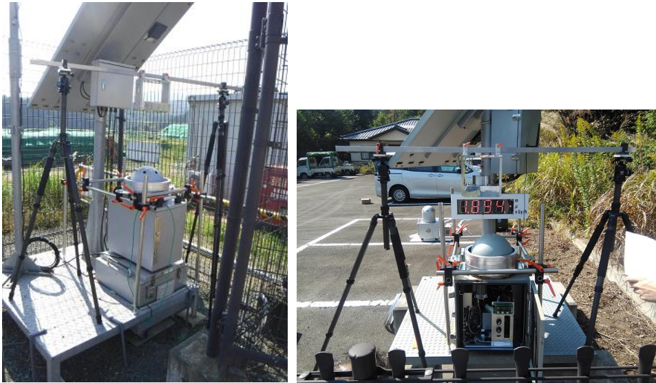
図 14 双葉町（左）及び大熊町（右）における設置されているモニタリングポストに対する校正風景
