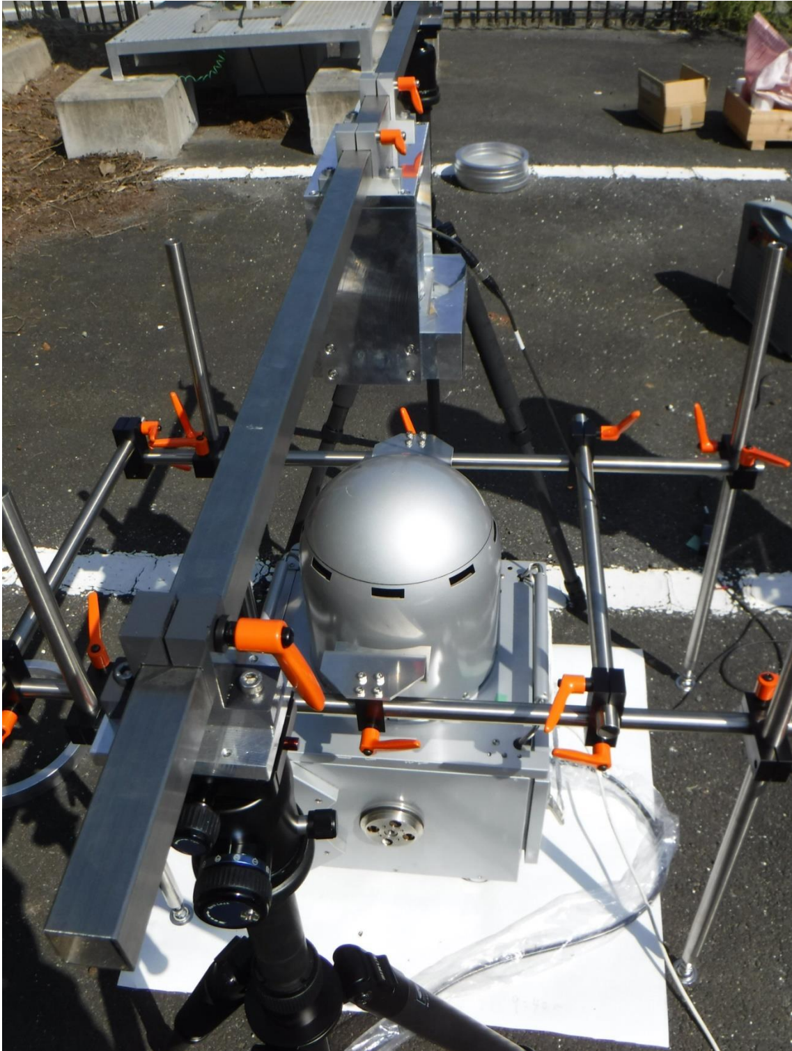
図 17 レーザー距離計による照射位置の調整風景
