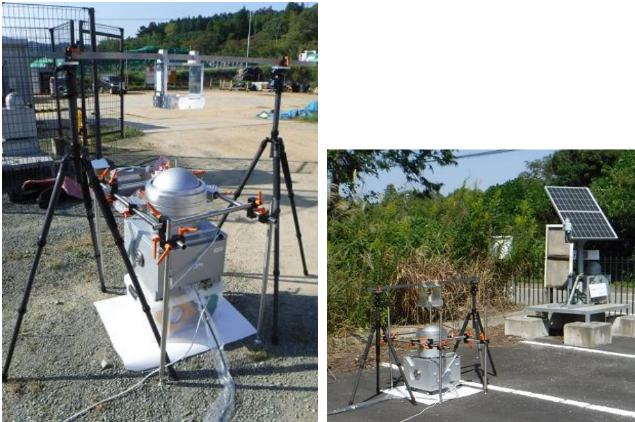
図 13 双葉町（左）及び大熊町（右）での可搬型モニタリングポストに対する校正風景
