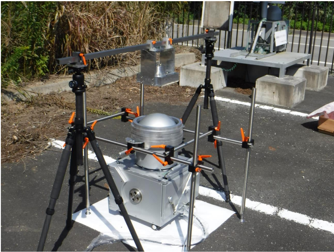
図 18 線源コリメータ及び遮へい体を配置した風景
