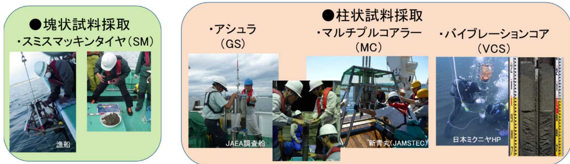
Fig. 4-17 福島第一原子力発電所の事故対応に用いられている主な採泥方法
