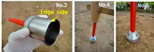
図 4. 2. 1. 7-5 100 mL の土壌コアサンプラーを使用した、圧縮された土壌の放射能汚染の調査のための緊急手順
