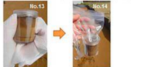
図 4. 2. 1. 7-4 U-8 容器を使用した土壌の放射能汚染の調査のための緊急手順
