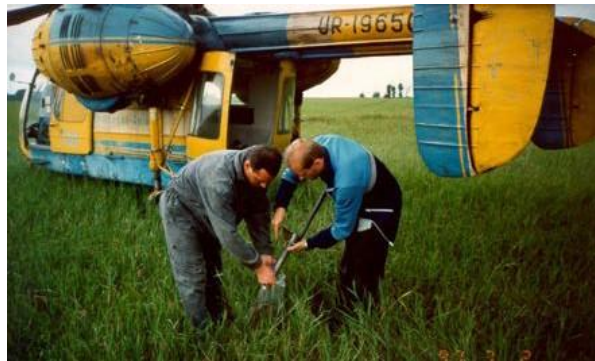
図 v-1-4 土壌のサンプリングの様子②（垂直分布調査用）
