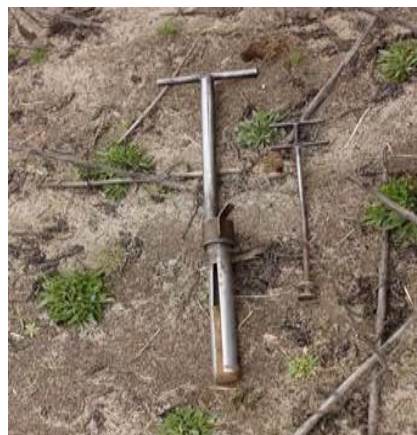
図 v-1-5 垂直分布調査用円筒サンプラー
