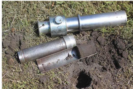
図 v-1-4 土壌のサンプリングの様子②（垂直分布調査用）
