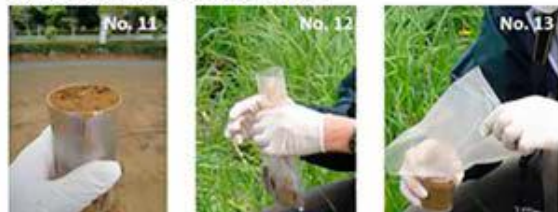
図 4. 2. 1. 7-5 100 mL の土壌コアサンプラーを使用した、圧縮された土壌の放射能汚染の調査のための緊急手順
