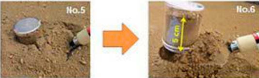
図 4. 2. 1. 7-4 U-8 容器を使用した土壌の放射能汚染の調査のための緊急手順
