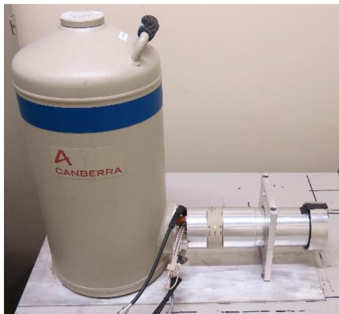
写真 3.3.2-1 JAEA 所掌のガンマ線検出器（検出器部） （Canberra Model: GL0515R S/N: 04034924）
