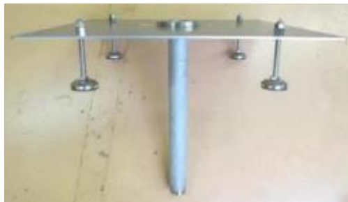
写真 3.2.2-1 J-MOX における AVIS 測定用グローブボックス底部を模擬した治具
