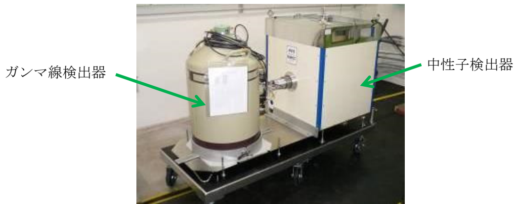
写真 1.1-2 AVIS の外観写真
