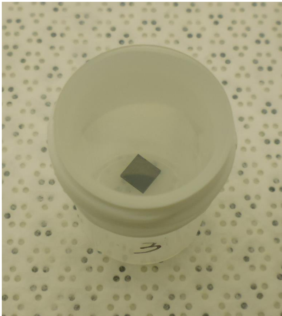
図-4.2 : U100 ウラン粒子溶解に使用したSiチップとPFA ジャー
