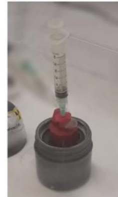
希釈液400 \mu lを入れた注射筒(針は38mm)を刺し、希釈液を容器内に入れる。
