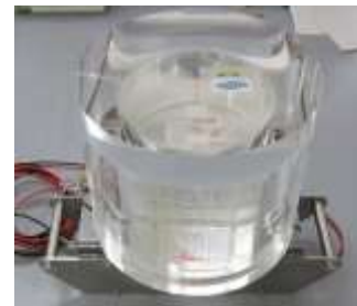
成人用配置 (PMMA20cm \Phi × 17cm)
