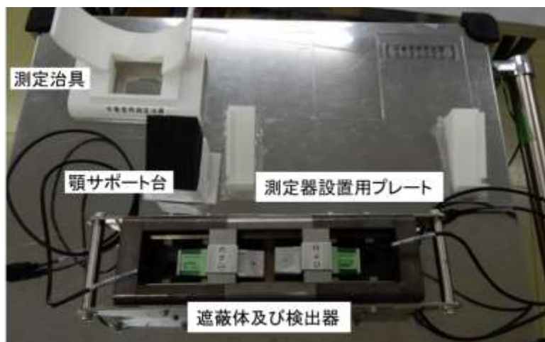
図3-1-1 甲状腺モニタシステムの機材一式
