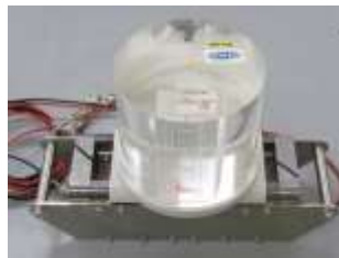
小児用配置 (PMMA13cmΦ × 12cm)
