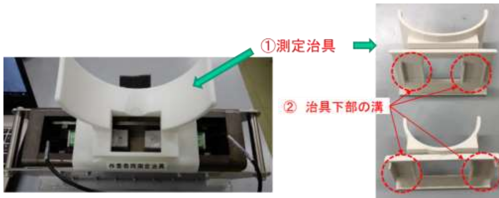
図3-4-1 甲状腺等価線量の測定に用いる測定治具
