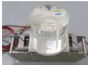
小児用配置 (PMMA13cm \Phi × 12cm)
