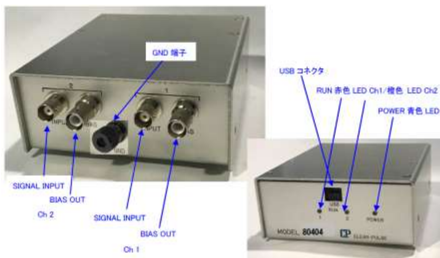
図 4-2-2-3-1 LaBr 3 (Ce)シンチレーション検出器用信号処理装置 (CP model 80404)
