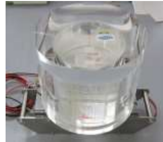
成人用配置 (PMMA20cmΦ × 17cm)
