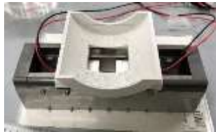
図3-3-1 甲状腺モニタシステムでのバックグラウンド補正用測定のセットアップ
