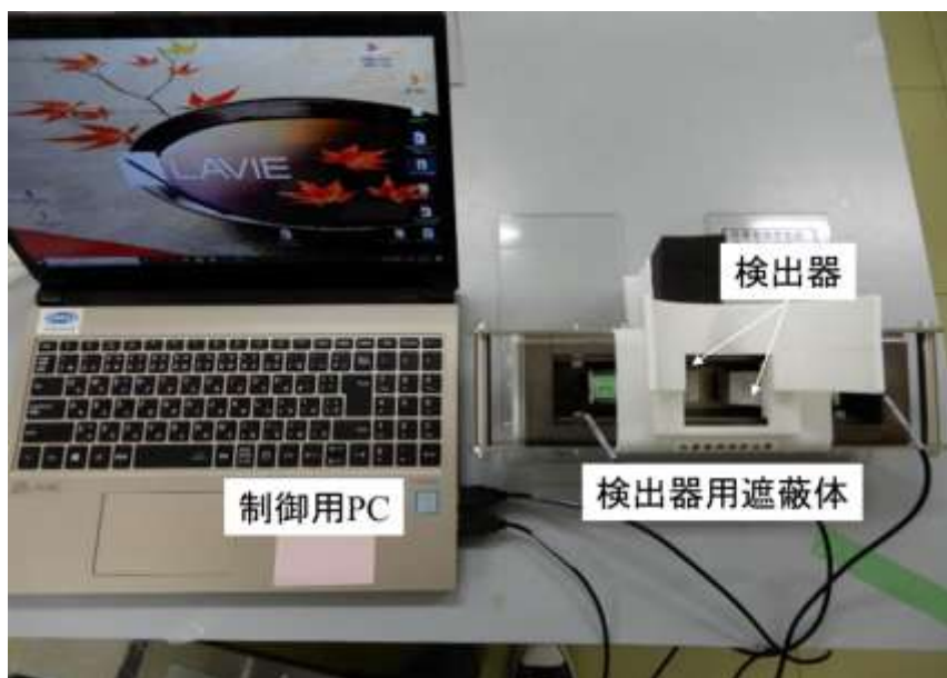
図 2-1 作業員用甲状腺放射性ヨウ素モニタシステムの写真
