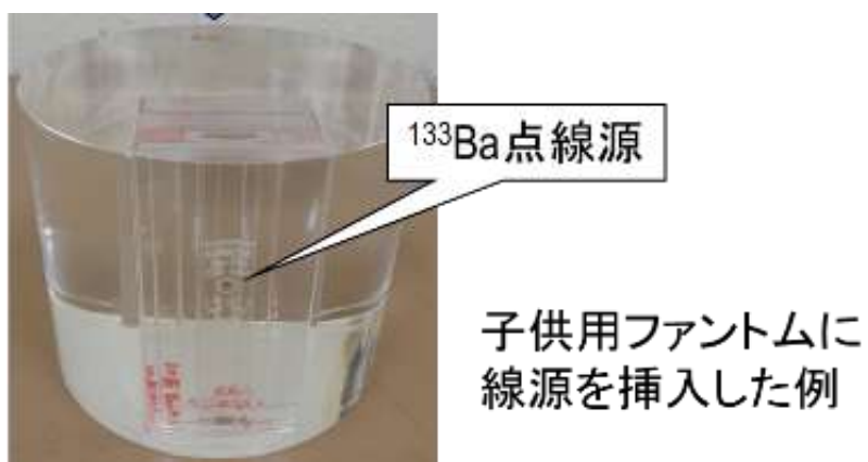
図 3-2-2 ファントムへ ^{133}\text{Ba} 線源の挿入 (小児用ファントムの例)
