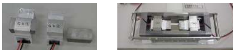
④上部遮蔽体と \text{LaBr}_3 検出器
