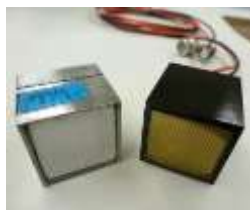
図2-2 LaBr 3 (Ce)シンチレーション検出器の写真
