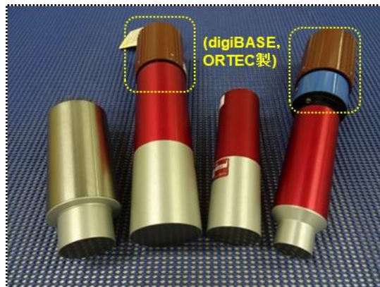
図 4 試験を行った市販 \gamma 線スペクトロメータの外観 (プローブのみ)
