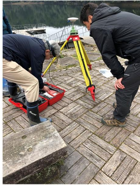
図 1.2-2-83 GNSS 受信機による測量。(a)浮棧橋上における測定(flt1, flt2)。(b)湖岸上における測定(fix1)
