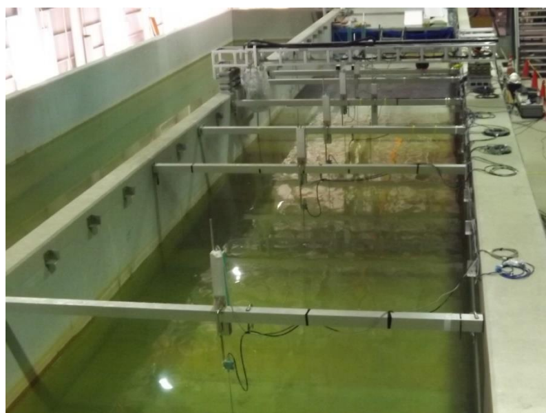
図 2-1-2(1) 計測機器・設置状況 (流速計・波高計)
