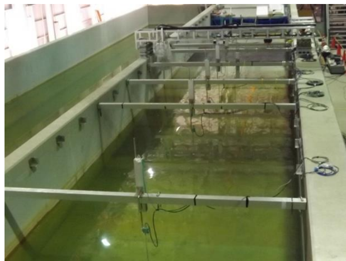
図 1-4-4 水位計設置状況
