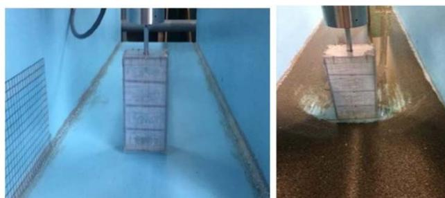
写真- 10.11 建築物模型の設置状況・土砂堆積状況例
