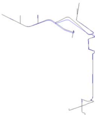
図 3.3.3-2 配管系モデルの 1 次固有振動モード
