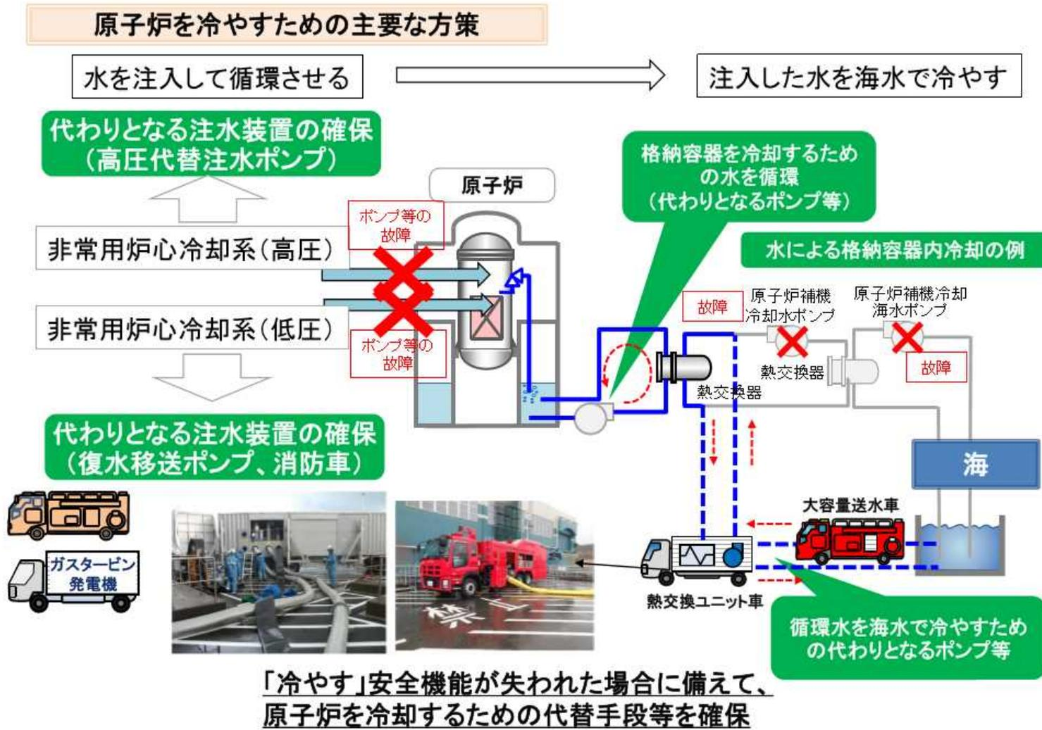
図 4.1-1 炉心損傷防止対策設備の整理図 (例)(東京電力 公開資料より抜粋)
