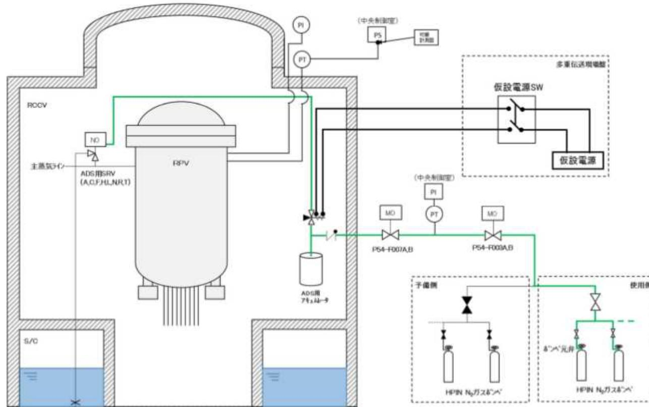
可搬型誤型バッテリーによる逃がし安全弁（自動減圧機能付き）解放手順
