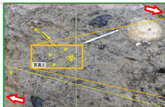
写真1 トレンチ底盤で観察された変形構造
