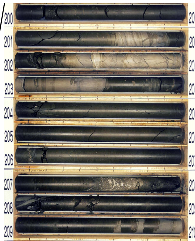
S-601孔 コア写真(深度200m~210m)
