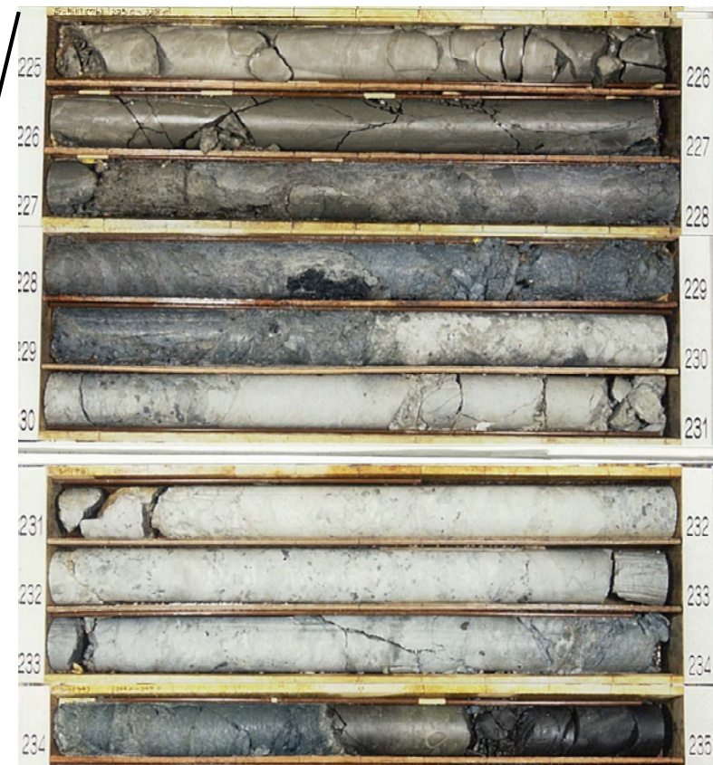
S-501孔 コア写真(深度225m~235m)
