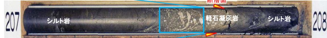
コア表面で見られる軽石の引きずり変形がCT画像(鉛直断面)でも認められ、引き延ばされた構造から変位センスは正断層であると判断される。軽石は低密度であるため、CT画像では暗色を呈する。
