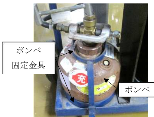
【技能訓練施設技能訓練棟】 アセチレンボンベ
