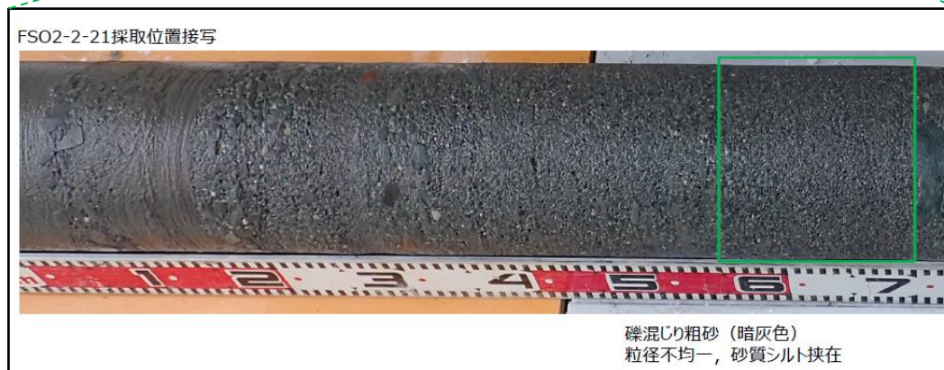
図 2-5 凍結サンプリング写真及び観察スケッチ (供試体番号: FS02-2-21)
