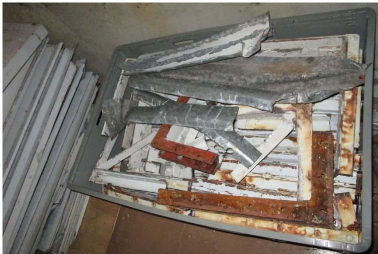
解体した排気筒のフレーム鋼材・補強アングル・スカート部分の保管状況。(令和2年6月23日撮影)
