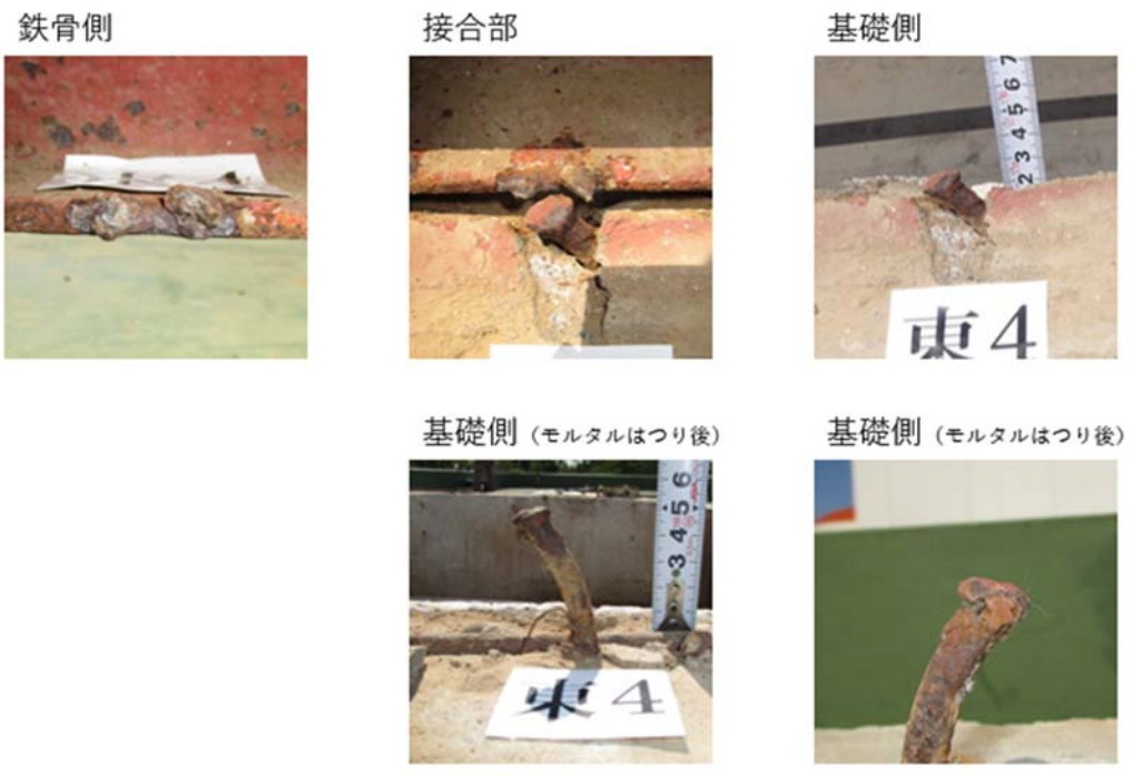
図 20 東 4 の写真 (“接合部”は、接合した状態を再現して撮影したもの)
