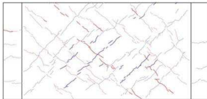
図 3-4 (6) 1/1000rad. におけるひび割れ図
