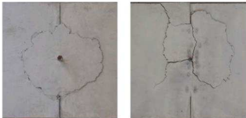
a) 試験体#1 (ひび割れなし) b) 試験体#2 (0.4mm)
