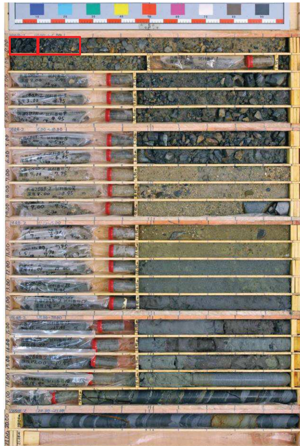
図 1.1-27 ボーリング柱状図・コア写真 (28QB-2)
