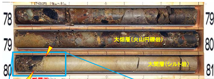
写真1 ボーリングコア(78m~81m) 断層面 (粘土状破碎部)
