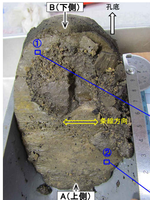
断層面の下盤上面の接写写真 横ずれセンスを示す明瞭な条線が認められる
