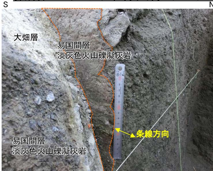
断層面の走向・傾斜
