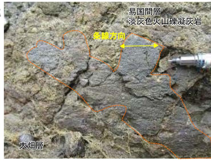
断層面の走向・傾斜
