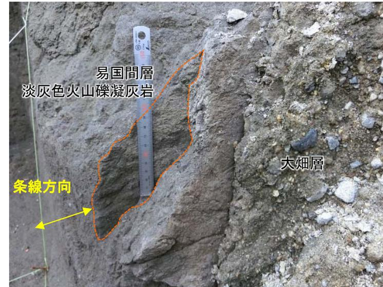
断層面の走向・傾斜
