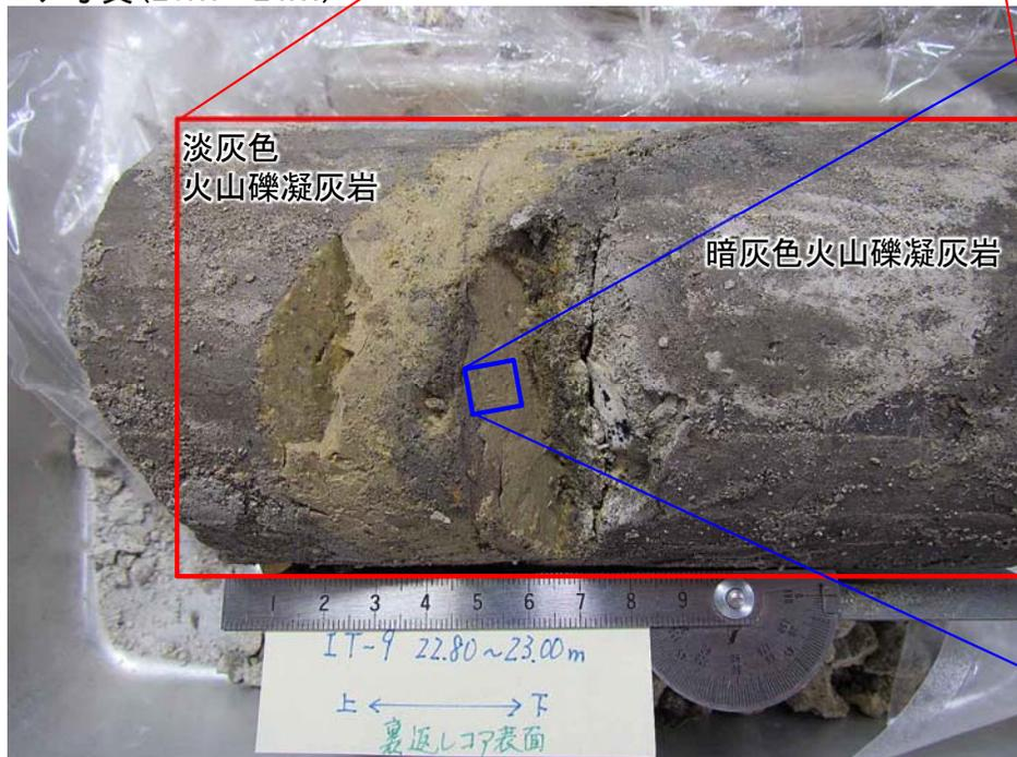
条線測定箇所の接写画像(赤色枠部の試料を裏返した状態)
