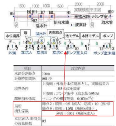
図 1.4-22 解析モデル (上)、解析条件 (下)
