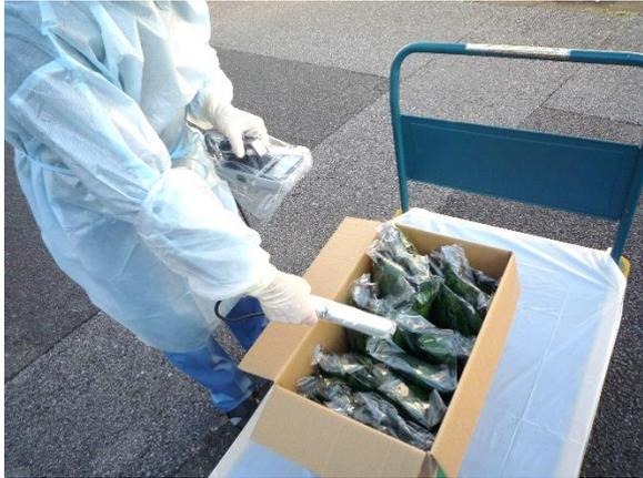
サーベイメータによる試料受入れ時の測定
