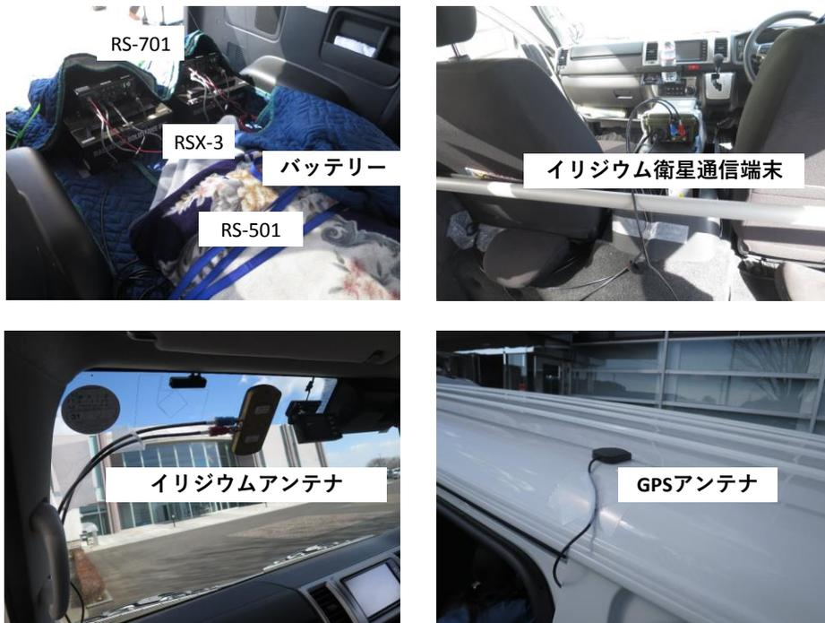
Fig. 5-6 リアルタイムデータ通信システムの動作試験におけるシステムの車両搭載状況
