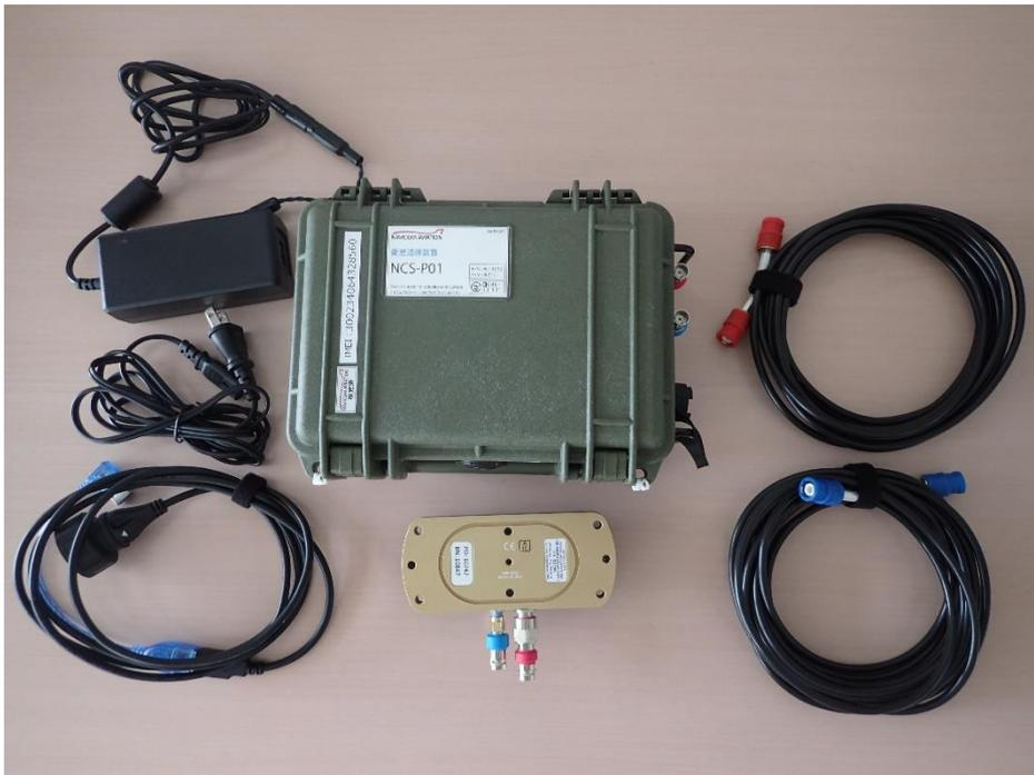
Fig. 5-1 イリジウム衛星通信端末の概観
